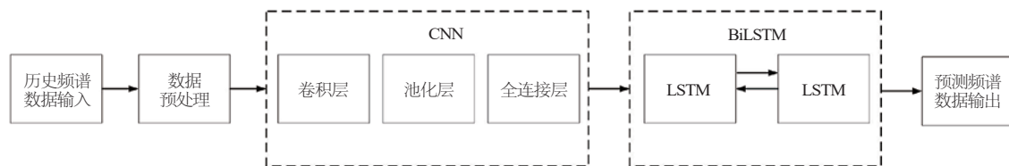
图7 CNN-BiLSTM预测模型网络结构
